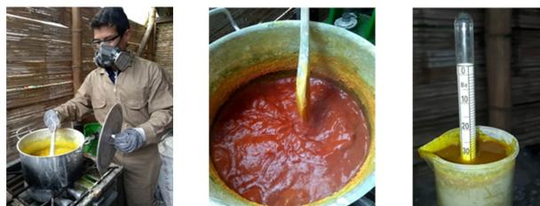
Figura 1. Preparación de polisulfuro de calcio. A. Mezcla de ingredientes; B. Coloración final, y C. Medición de la densidad.
